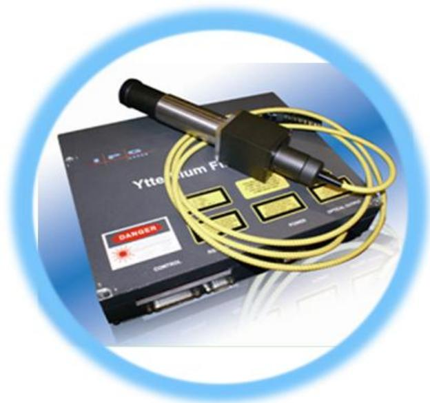
光纤激光器一体化整体结构，无光学污染、无功率的耦合损失，结构小巧紧凑，空气冷却，具有其他激光器不具备的高效率和可靠性。光纤激光器是以激光二极管为泵浦源的掺镜光纤激光器，简称以Yb3+。由激光电源给激光二极管供电来激励Yb 光纤发出激光。通过光纤传输到振镜头。输出激光通过由计算机控制的振镜反射偏转，经F- $\theta$  透镜聚集到工作表面，形成高功率密度光斑。使工件表面瞬间气化，刻蚀出一定深度的图案文字。
