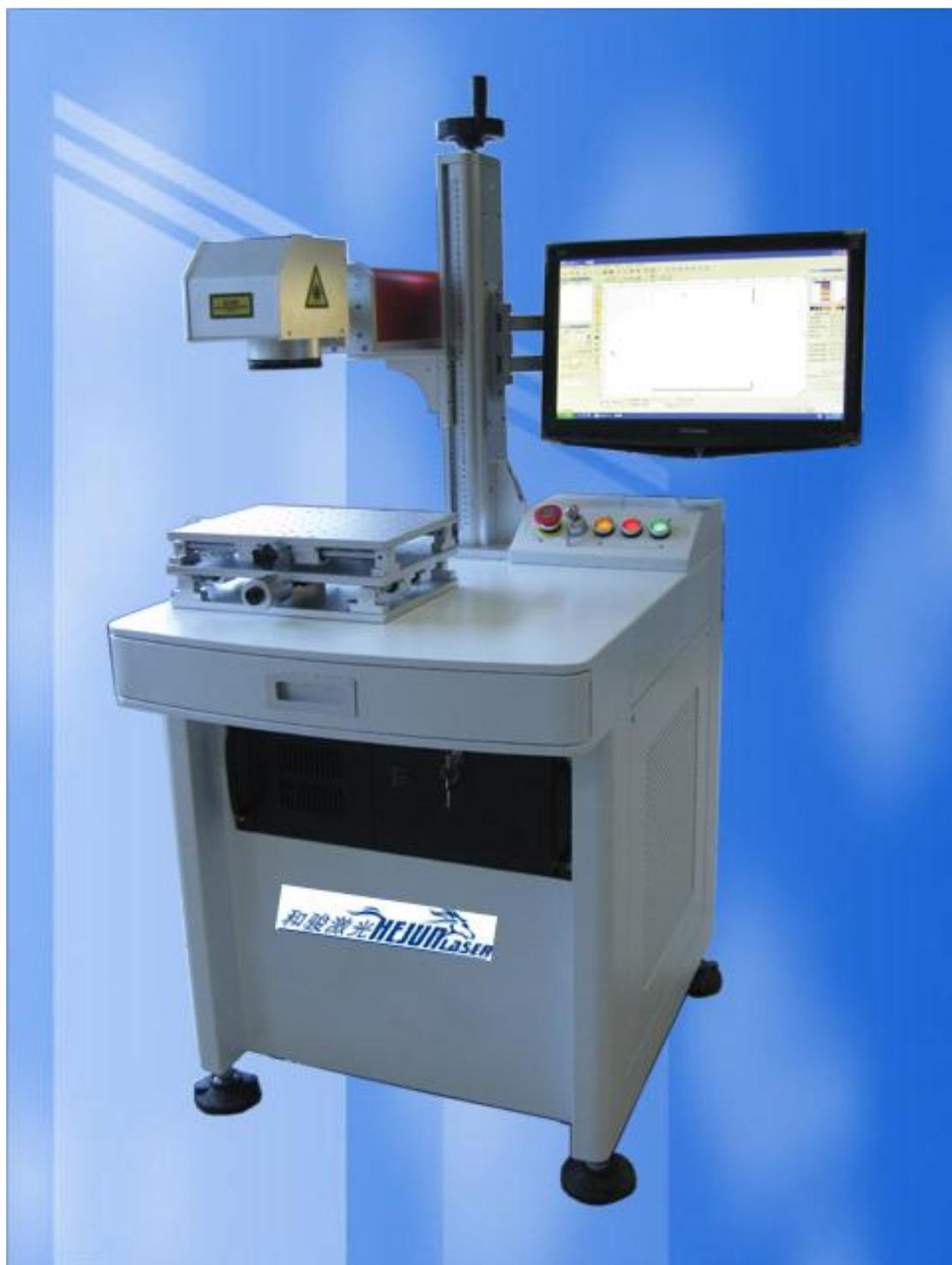
HJZJ-F-20 光纤打标机是和骏激光公司的先进产品之一，它是一项新颖、高性能的OEM 设备，是为高速和高效的激光打标系统而专门发展的。与传统的二极管泵浦激光器（包括Nd:YAG 激光器）相比JHMS-50 激光打标机的主要优点是它使用Q 调制的主振荡和一个增益值为50-60 dB 的高功率光纤放大器技术（MOPA）
